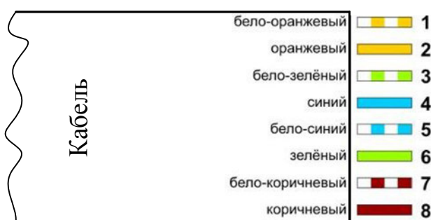
Рисунок 1 – Схема расположения проводов на контактах разъема типа RJ-45
