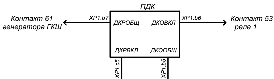
Рисунок 4.6 – Включение ПДК в систему частотного диспетчерского контроля в разрезных сигнальных установках однопутной кодовой автоблокировки
