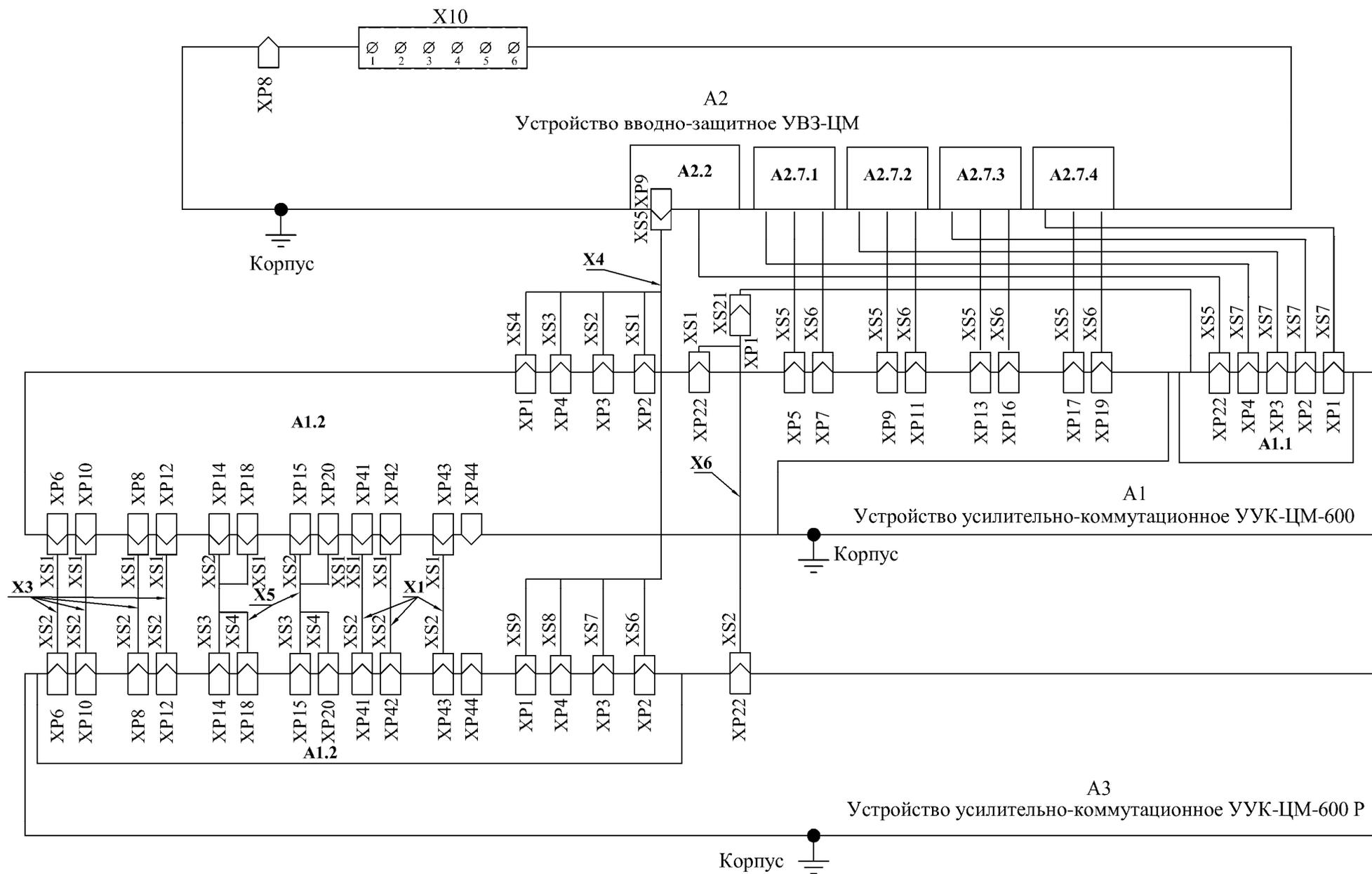
Рисунок Б3. Схема электрическая соединений SKU.MD-600-xxx
