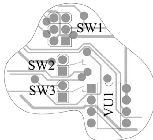
Рисунок 9 – Установка перемычки управления пожарным отключением
