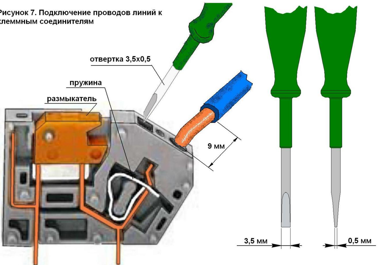
4.2.1.5 К клеммной колодке на задней панели УВЗ-ЦМ подключите линию пожарного отключения, линию дистанционного включения (без учета полярности), линию резервного питания в соответствии с рисунком 8.
