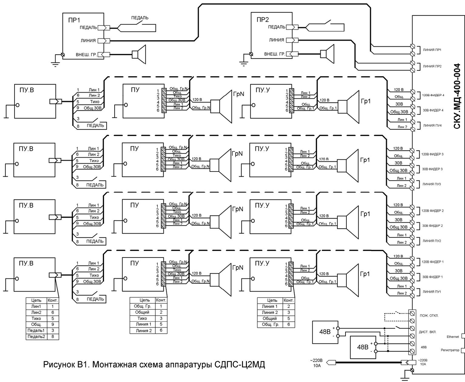
Рисунок В1. Монтажная схема аппаратуры СДПС-Ц2МД
