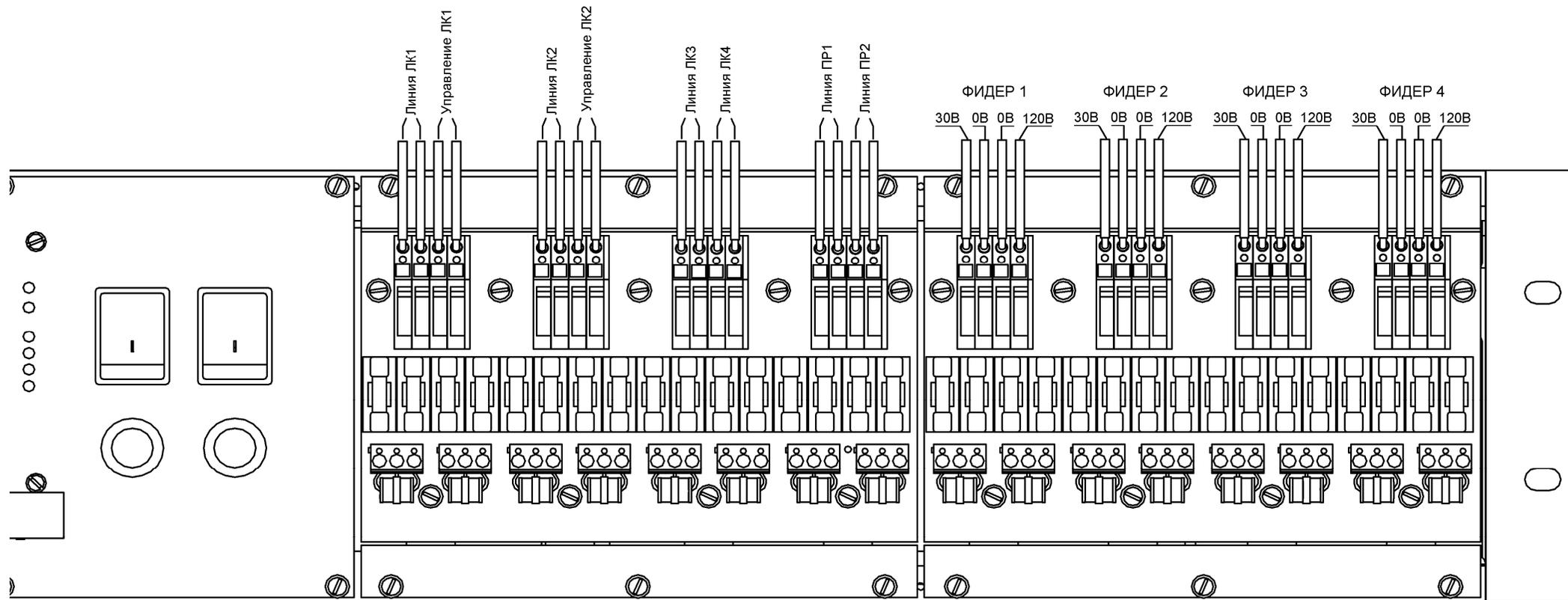
Рисунок 6. Подключение линий терминального оборудования.
