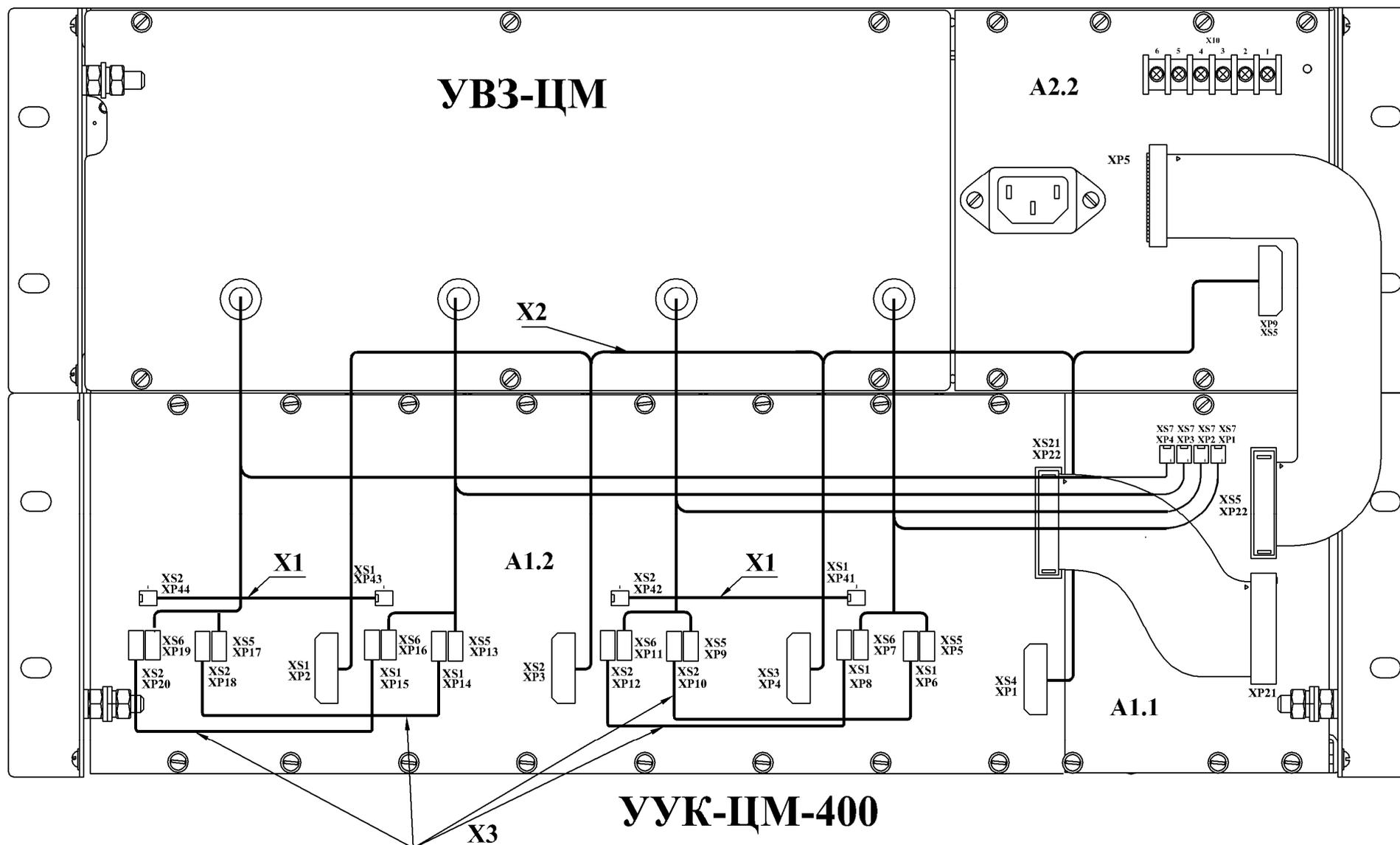
Рисунок 4. СКУ.МД-800. Межблочные соединения. Вид сзади
