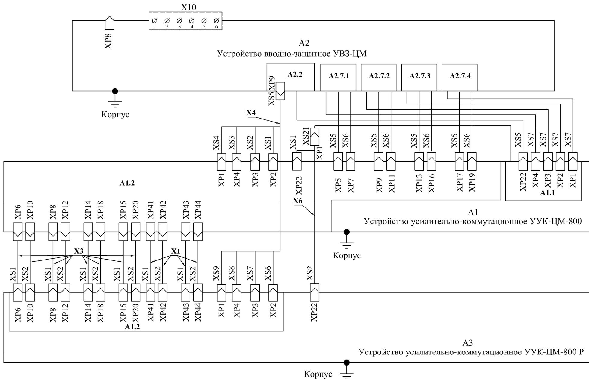
Рисунок Б4. Схема электрическая соединений SKU.MD-800-xxx
