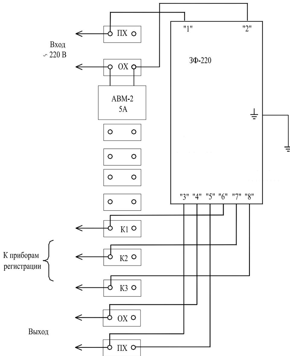
**Примечание:** Для включения подогрева в клемму выход «ПХ» установить перемычку.
