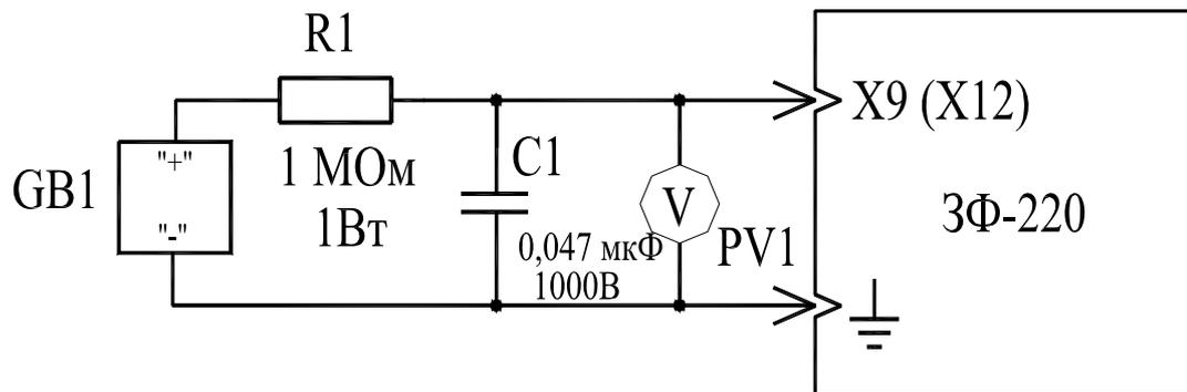
**Рисунок Г.2** Схема проверки напряжения срабатывания разрядников FV1,FV2
