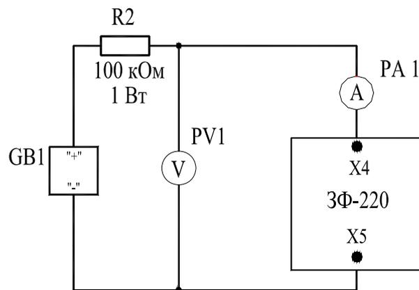
**Рисунок Г.3** Схема измерения классификационного напряжения варистора RU1
