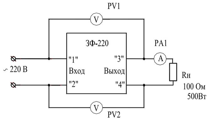
**Рисунок Г.1** Схема проверки значения падения напряжения на 3Ф-220 при токе нагрузки 2,2 А
