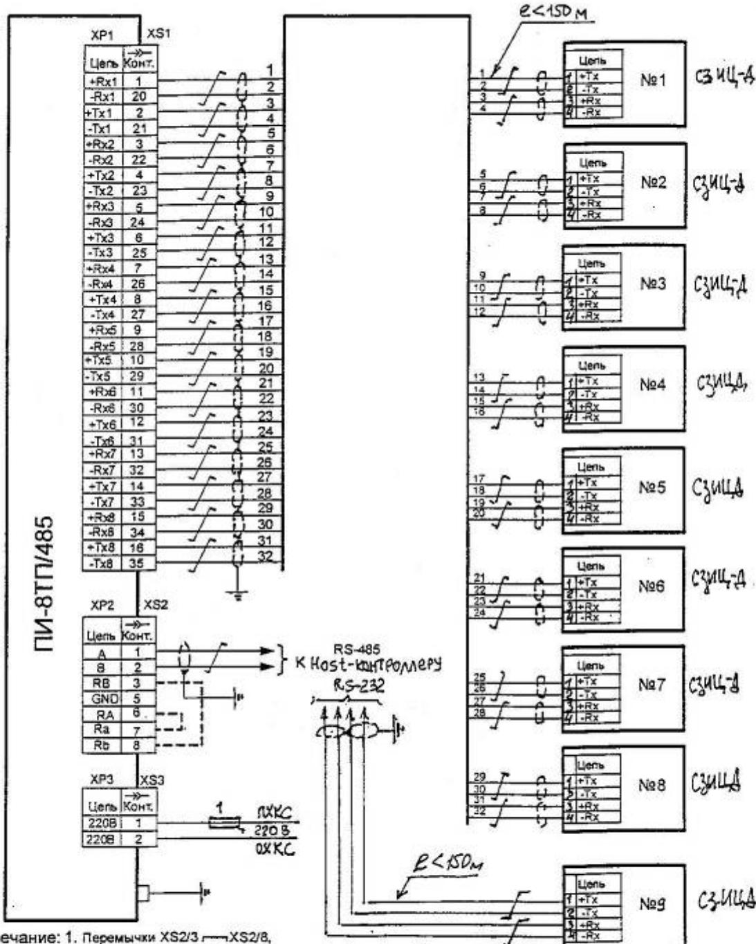
Примечание: 1. Перемычки XS2/3 — XS2/8, XS2/6 — XS2/7 устанавливаются в случае, если прибор ПИ-8ТП/485 является окончным устройством.
