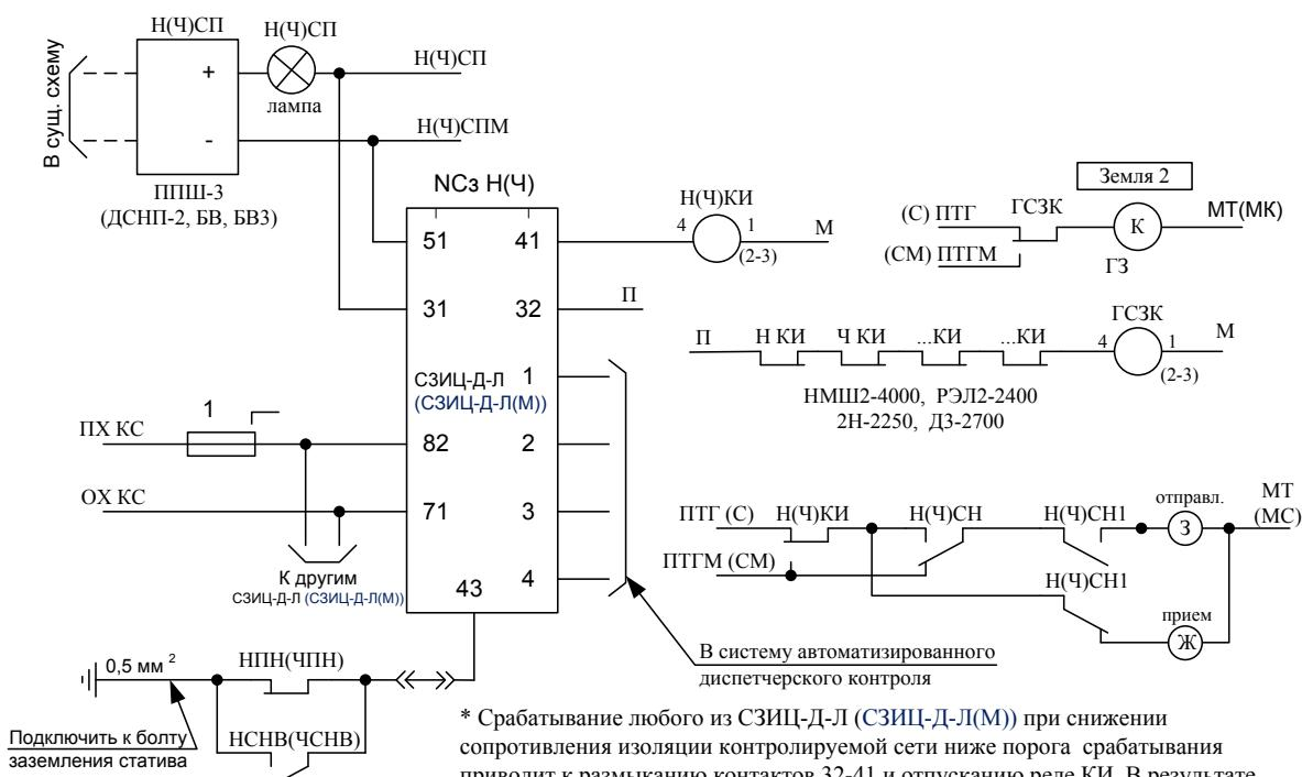
\* Срабатывание любого из СЗИЦ-Д-Л (СЗИЦ-Д-Л(М)) при снижении сопротивления изоляции контролируемой сети ниже порога срабатывания приводит к размыканию контактов 32-41 и отпусканию реле КИ. В результате обесточивается групповое реле ГЗСК, включенное через фронтовые контакты индивидуальных реле КИ. При этом на табло загорается мигающим светом красный светодиод “земля 2” и индивидуальный светодиод №КИ срабатывания соответствующего СЗИЦ-Д-Л (СЗИЦ-Д-Л(М)).
