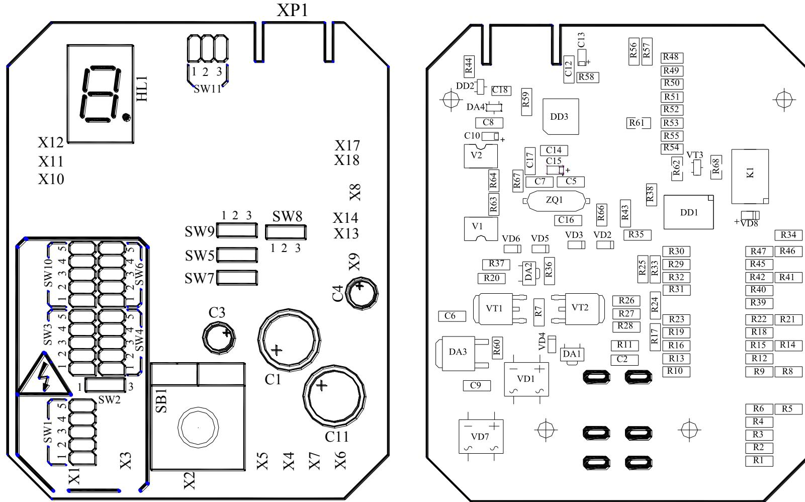
**ПРИЛОЖЕНИЕ В****(обязательное)****Схема установки перемычек на плате**
