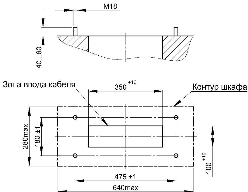
Рисунок 1 – Место установки шкафа ШРП-600
