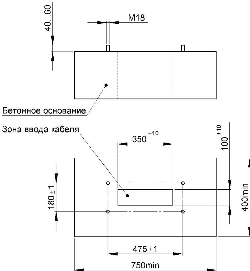
Рисунок 1 - Место установки шкафа ШР-300
