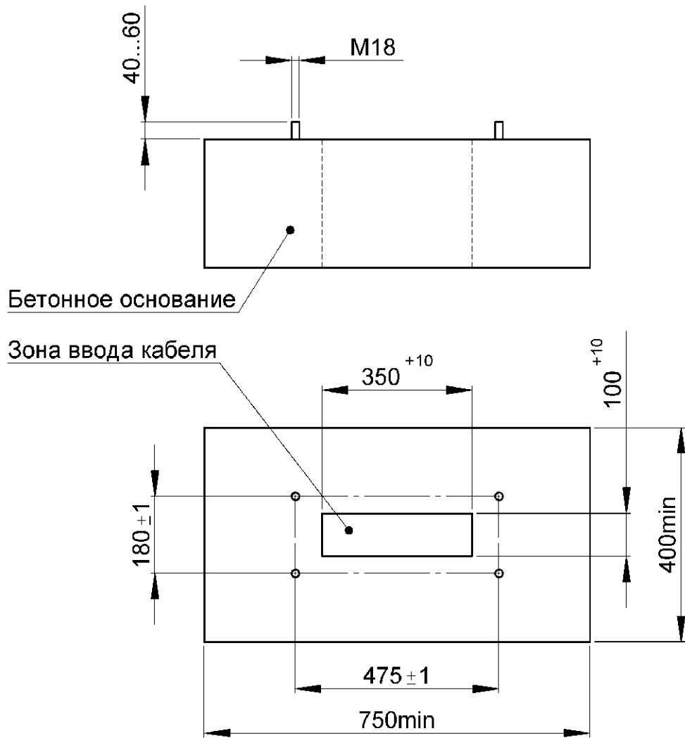
Рисунок 1 – Место установки шкафа ШР-150
