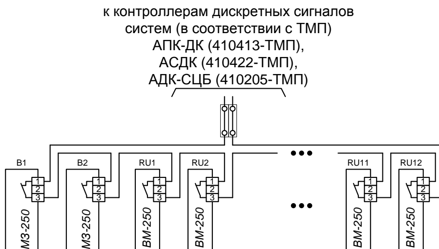
Рисунок 43 – Схема подключения АС ТДМ к модулям второй ступени защиты (при использовании приборов без резервирования, шкаф №1)
