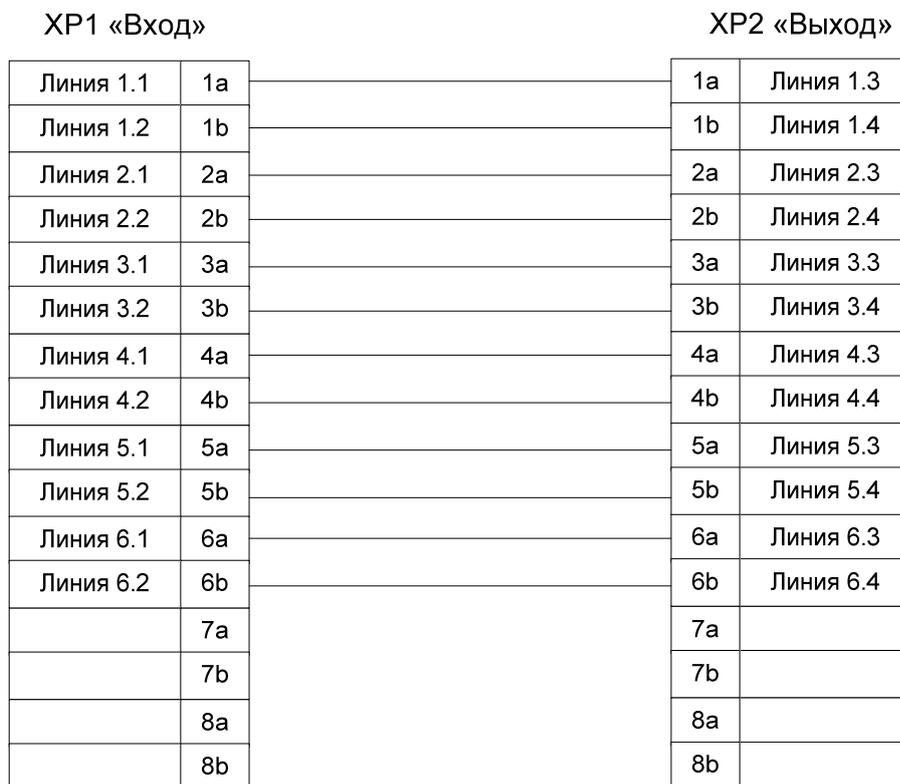
Рисунок Г.3. Схема электрическая принципиальная шнура кроссировочного ШК-16.
